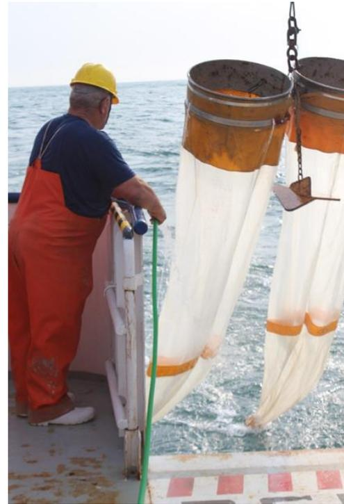
Figura 05. Detalhe da amostragem em rede de arrasto vertical (à esquerda) e da rede bongô (à direita).
