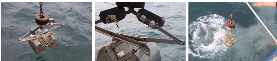
Figura 10: Lançamento do amostrador de fundo do tipo Van Veen.
